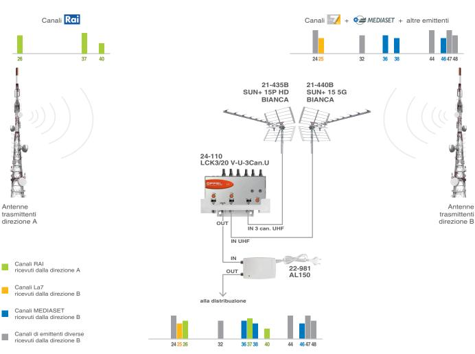
Canali UHF amplificati all'uscita del centralino
