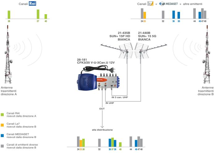
Canali UHF amplificati all'uscita del centralino
