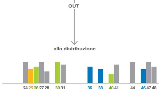
Canali UHF amplificati all'uscita del centralino
