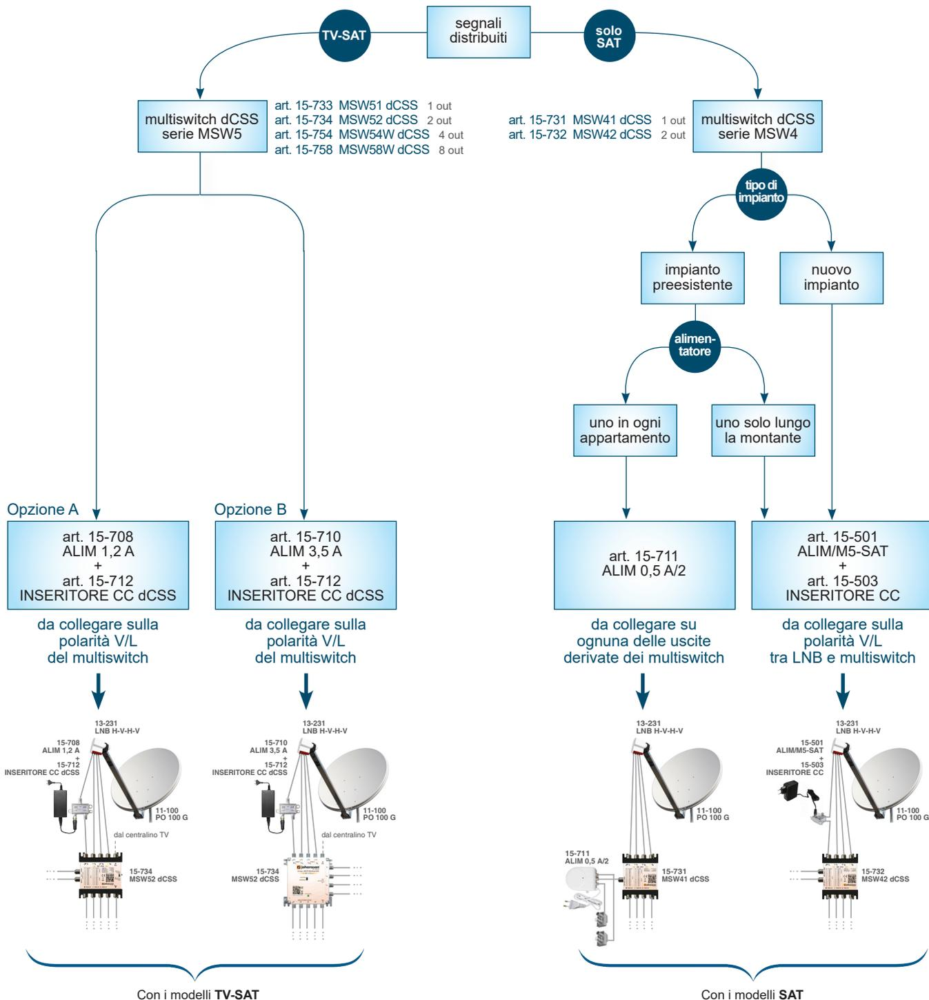
ad 1 o 2 uscite derivate è necessario un alimentatore ogni 4 multiswitch.
